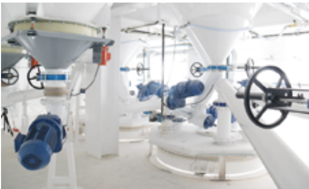
1. Pesado de materias primas mayoritarias. Weighing of main raw materials.
