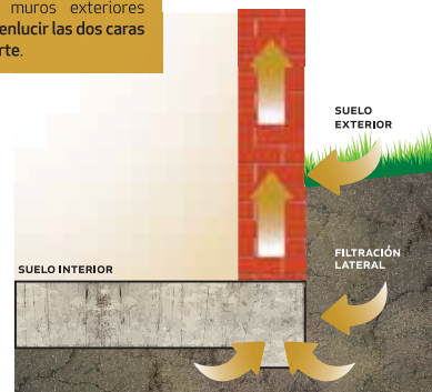
FOCOS DE HUMEDAD POR CAPILARIDAD
